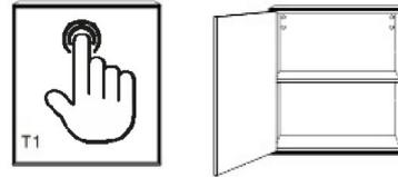
Durch einen leichten Druck auf die Front des Möbelstücks wird ein Mechanismus ausgelöst, der die Schublade, die Klappe oder die Tür automatisch öffnet.
