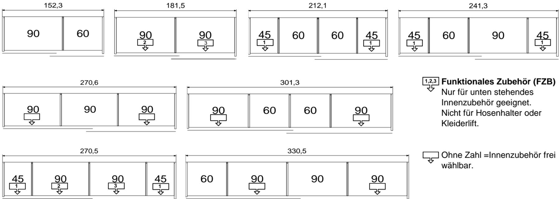
Innenschubkästen für Schieber, müssen mit einer Blende L/R ausgestattet sein, damit sie bei aufgeschobener Tür zu öffnen sind.
